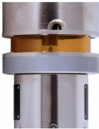
Bruker с гордостью представляет систему IntraSpect 360. Будучи новейшим представителем семейства механических испытательных приборов Hysitron, IntraSpect 360 обеспечивает количественную характеристику механических свойств для рентгеновских микроскопов (XRM) и линий пучка. Эта уникальная система может использоваться для выполнения различных механических испытаний, таких как вдавливание, сжатие, усталость и изгиб, которые затем можно соотнести с 2D или 3D изображениями с главного микроскопа.
