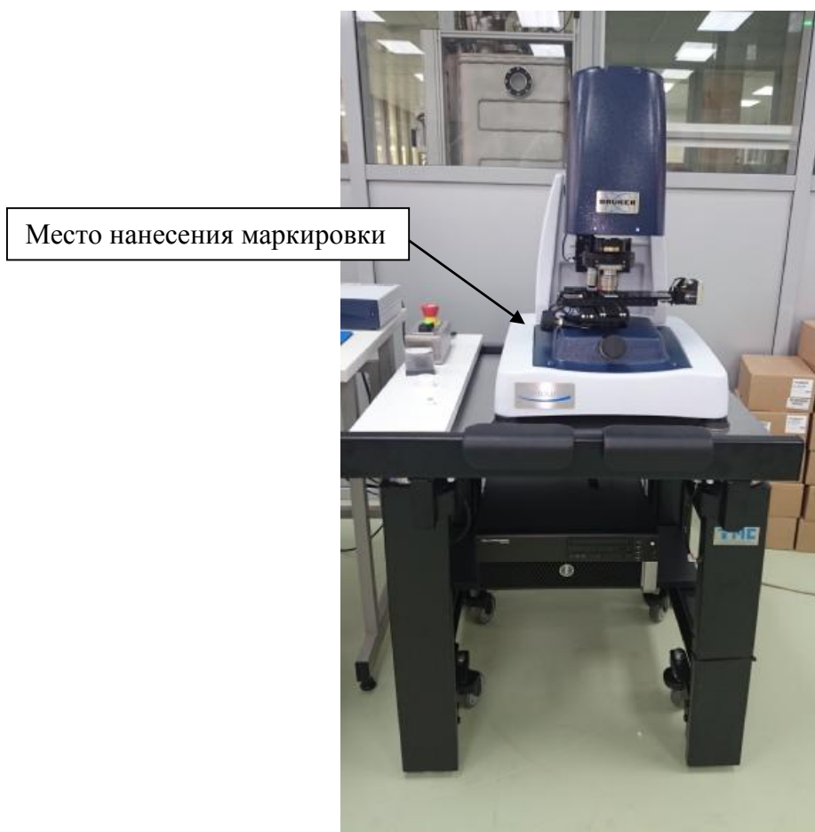
Рисунок 1 – Общий вид профилометров оптических ContourGT-K с указанием места нанесения маркировки
