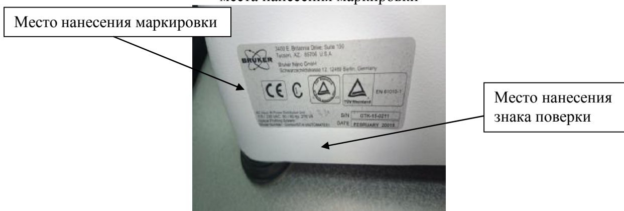
Рисунок 2 – Профилометр оптический ContourGT-K (вид сзади) с указанием мест нанесения маркировки и знака поверки
