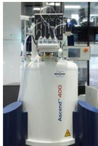
Система расположена поверх системы ЯМР \* . Проточная трубка, соединенная с ее линией передачи, вставляется в магнит до тех пор, пока не достигнет зонда.
