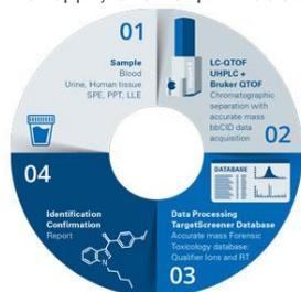
Схема рабочего процесса Bruker TargetScreener
