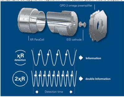
Технология 2xR, позволяющая выполнять быстрый изотопный анализ тонкой структуры (IFS) со скоростью.
