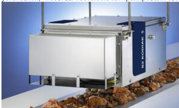
S2 KODIAK - Многоэлементный анализатор XRF для получения результатов в реальном времени в майнинге
