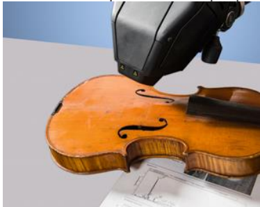
ELIO - Портативный спектрометр Micro-XRF во время анализа скрипки Страдивари
