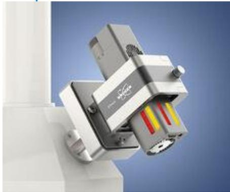
Рентгеновское возбуждение гораздо более эффективно, чем электронное возбуждение в диапазоне средних и тяжелых элементов, чувствительность в 20-50 раз выше. В зависимости от элемента и матрицы могут быть достигнуты пределы обнаружения до 10 промилле. Это позволяет анализировать микроэлементы в SEM.
