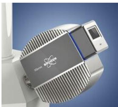
Спектрометр XSense достигает энергетических разрешений в диапазоне 4 эВ для излучения Si K $\alpha$ . Оснащенный 6 дифракционными (анализирующими) кристаллами, он охватывает диапазон энергий от 100 эВ до 3,6 кэВ. Большое количество кристаллов с частично перекрывающимися энергетическими диапазонами обеспечивает выбор наилучшего соответствия для текущей задачи.
