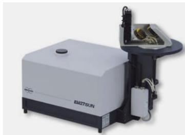
Новая серия спектрометров EM27/SUN представлена трассовыми FTIR анализаторами, предназначенными для контроля атмосферы. Измерения газов, таких как углекислый и метан и пр., производятся методом солнечной абсорбционной спектроскопии с использованием солнечного трекера. Управление трекером осуществляется с помощью инновационной системы, оснащенной видеокамерой.
